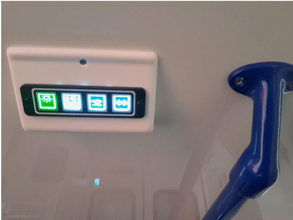
Steuerung Hubtisch Fahrtrage an der Decke auf Höhe des Patientenkopfes
