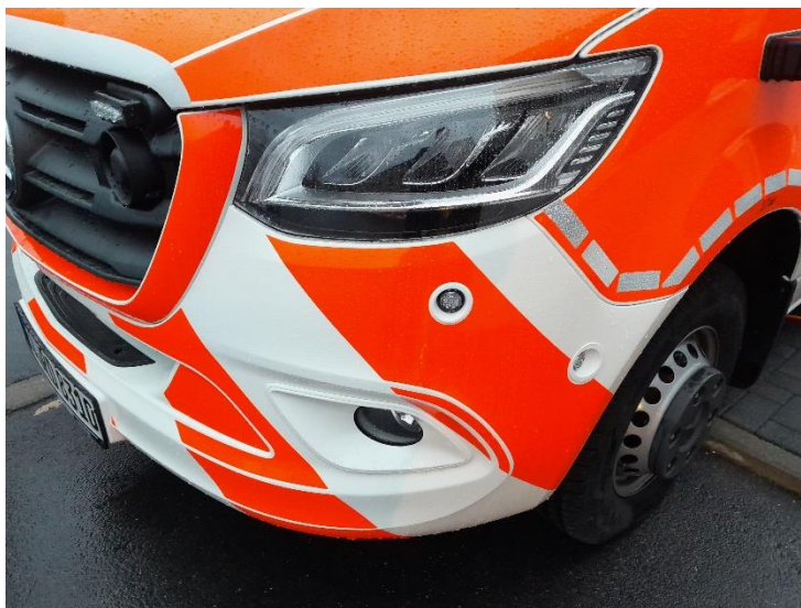
Beklebung Stoßstange und Verbau Kreuzungsblitz. Achtung: Hier noch mit Gaps.
