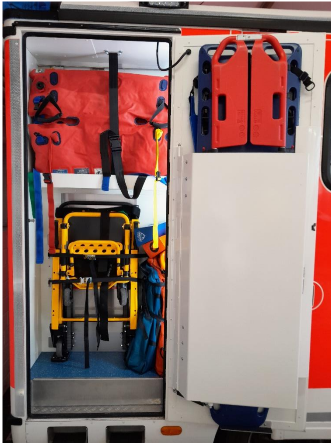
Vakuummattzenschrank von außen, mit Türfach für Schaufeltrage und Spineboard
