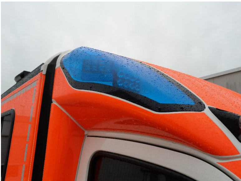
Integriertes, zweistufiges Blaulicht mit Powerblitzmodul nach vorne gerichtet
