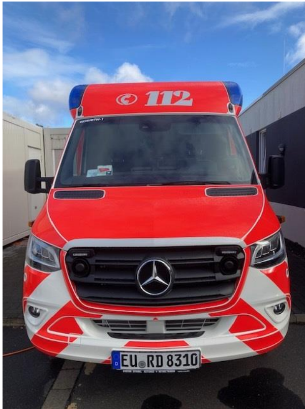
Frontansicht mit Verbau der Signalanlage, Kreuzungsblitzer und der Frontblitzer
