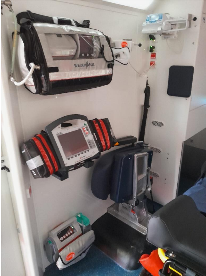
Halteungen für Medizintechnik, Greggersendose, Spannungsversorgung an der rechten Seitenwand, Spannungsversorgung C3
