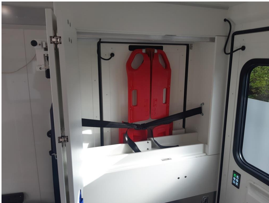
Vakuummatratzenschrank von innen zu öffnen, Achtung Türe im Bild falsch angeschlagen
