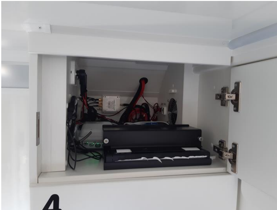
Technikfach über dem Apothekenschrank TNA RTW mit allen Geräten
