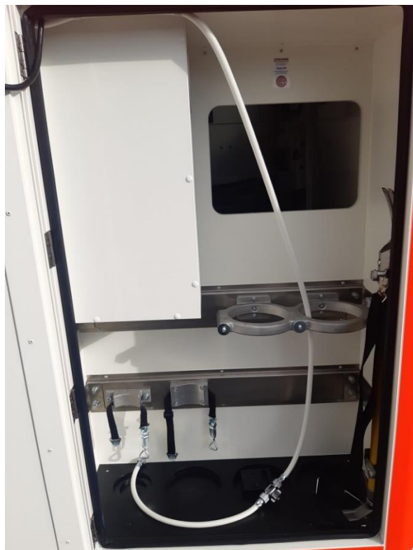
Sauerstoffschrank inkl. Halterung für Art Attack, Feuerlöscher, Sauerstoffflaschen, Unterlegkeil
