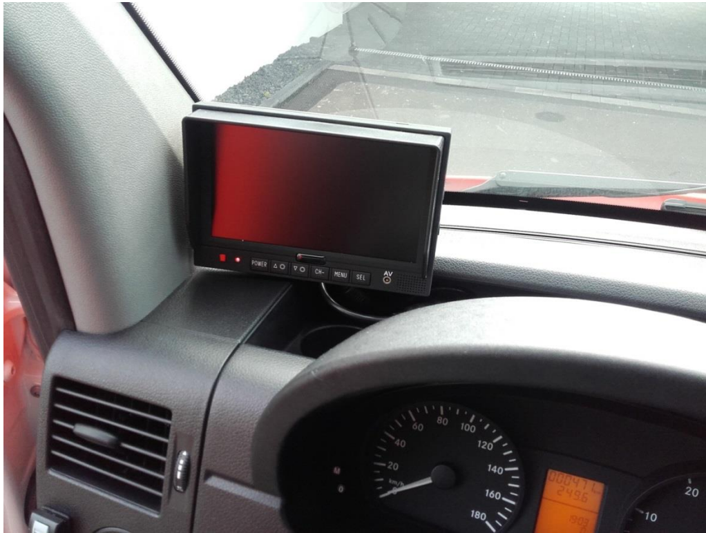
Verbau des Rückfahrmonitors neben der A-Säule
