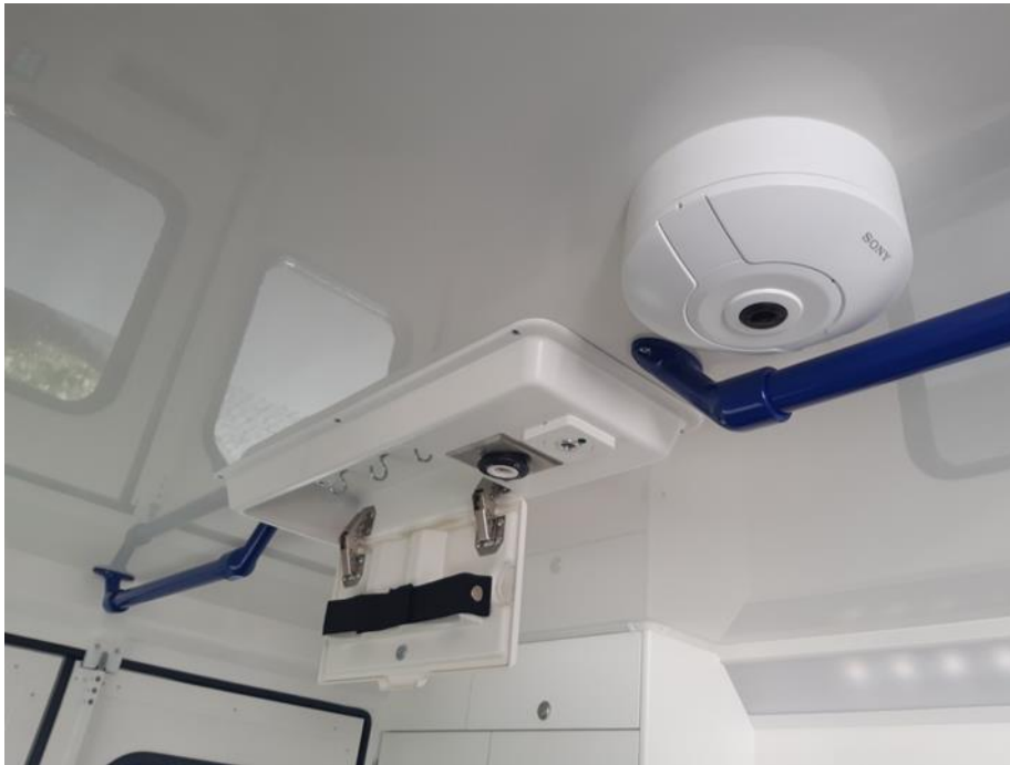
Verbau Deckencenter und TNA Kamera
