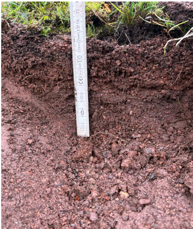
Abb. 7: Profilaufnahme SG 7 – Tennenbelag Kugelstoß-Anlage
