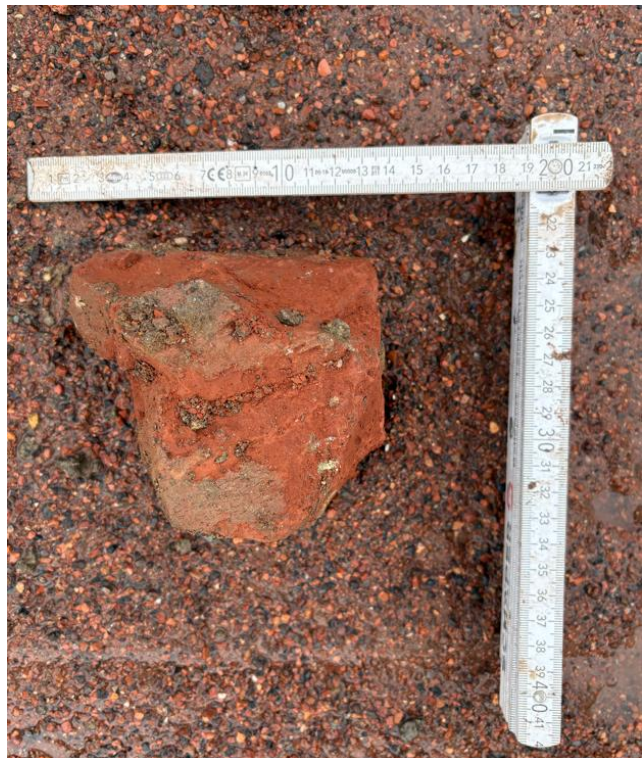
Abb. 8: oberflächennah vorgefundener Ziegelbruch im bindigen Auffüllungshorizont
